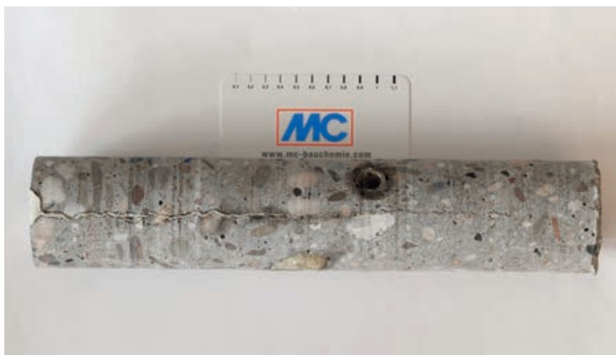
Ta próbka zainiektowanego elementu budowlanego wyraźnie pokazuje głębokość penetracji żywicy MC-Injekt 2133 flex, aż po najdrobniejsze mikropęknięcia.
